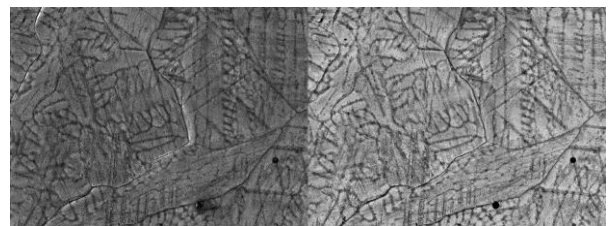
REM-Aufnahme von einer Zink-Schicht auf Stahl
